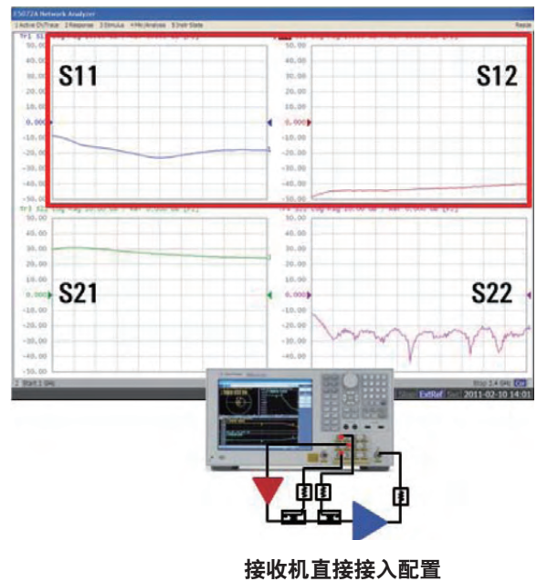
图 6. 使用推动放大器在大功率激励下测量放大器的结果比较
