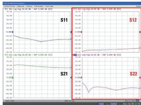
非耦合功率 (端口 1 = -40 dBm, 端口 2 = 0 dBm)
