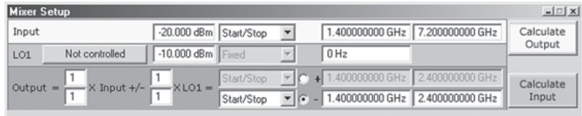
图 24、将频率范围设定到覆盖 f_1 \sim 3f_2
