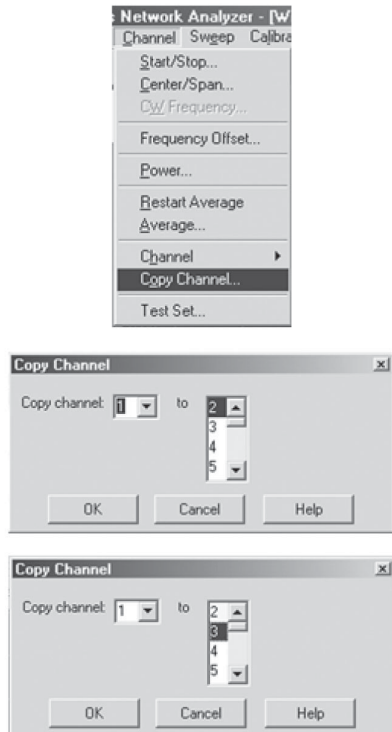
图 22、将通道 1 复制到通道 2 和 3 上，以便复制信号源功率校准
