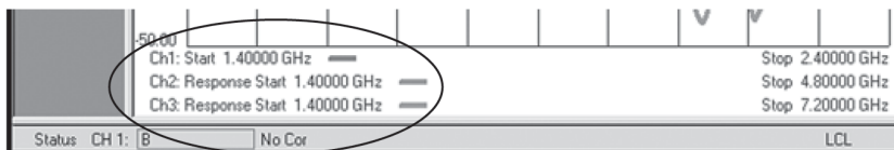
图5. 频率范围表明分析仪器是在标准方式还是在频偏方式
